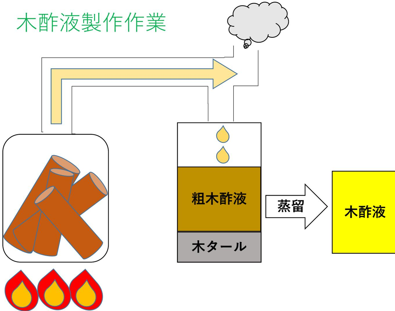
左図の様に木炭を制作する際に出る煙を配管に通して冷却し回収した粗木酢液を蒸留する事で得られる。ただし今回は蒸留装置の予算がなかったため半年間放置しタールと分離したものを利用した。
